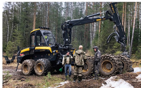
Харвестер «Ponsse»: валит лес, обрезает сучья, режет на сортимент, заменяет три бригады ручных вальщиков.
