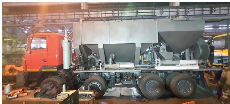
Эмульсионная смесительно-зарядная машина (новая продукция завода), этап сборки. Уже прошла пусконаладочные работы и находится в работе в Монголии.
