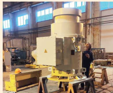
Новый двигатель переменного тока мощностью 1000 кВт.
